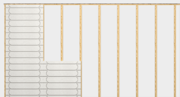
Pose des éléments chauffant sur l'ossature au moyen de vis autoperceuses fermacell™ 3,9 x 40 mm ou par agrafes de longueur 50 mm
