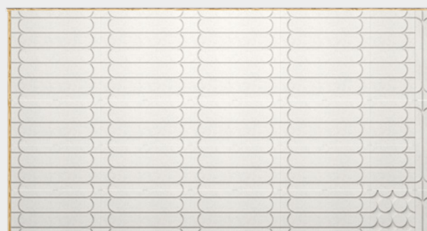
Application des éléments de chauffage de façon à créer une boucle
