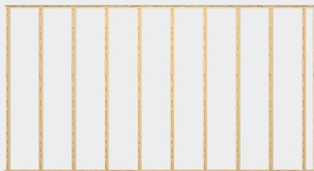
Entraxe de l'ossature max. 500 mm
